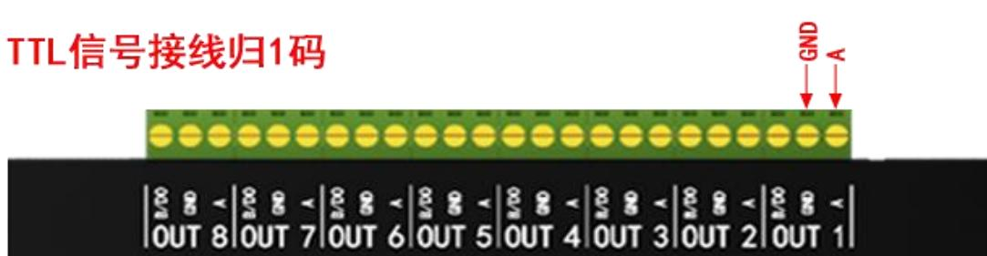
输出 DMX512/HDMX/TM512/UCS512/SM16512 控制信号（差分 RS485）时，需要三根线；输出 WS2811/TM1804/UCS1903/GS8206 等控制信号（TTL）时，需要两根线。
